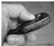
Pressionar **3 vezes** o botão do controle-remoto. O intervalo entre as transmissões deverá ser de 2 a 10 s. Se demorar mais de 10s para efetuar a 2<sup>a</sup> ou 3<sup>a</sup> transmissões, um bip longo é emitido. Uma nova sequência deverá ser feita.
